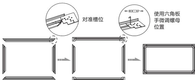
注：框架完成安装后，轻拍A、B处，如出现对接有缝隙，将角码轻拧调整，直至无缝隙，最后紧固。如图：
