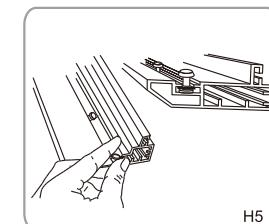
3. 将横框架和竖框架按照图示方向对接，放上铸铝固定角码连接件，调整角码连接件的位置，使角码连接件的孔与两条框架的孔对齐，然后拧入铸铝固定角码连接件螺丝并将其拧紧。最后按照同样的方法将其他三个角位安装好。(见图6-图7)
